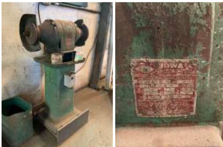
Item 26.a: MOTO ESMERIAL - MARCA SCHULZ N.º 5320 C/MOTOR ELETRICO MONOFASICO, 1/2 CV 3425 RPM (pequeno)
