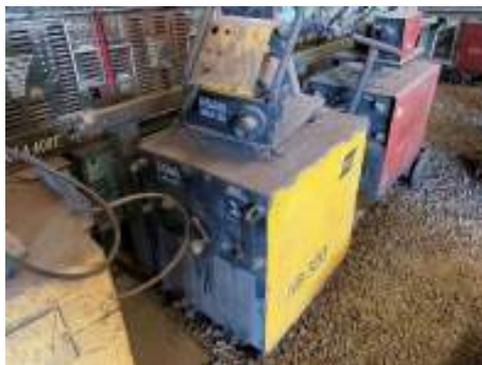
Item 02.a: MÁQUINA MIG MAG RETIFICADORA DE SOLDAGEM WELDING RECTIFIER - ESAB LAB 320 N.º 983559 C/CABEÇOTE ESAB MOD.MEF.30-A980830 - TOCHA 3M. REGULADOR DE DE PRESSÃO -W.W.MODELO R.86-A ARGONIO
